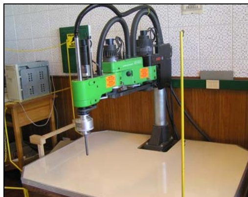
Fig. 1. Manipulador industrial BOSCH SR-800
