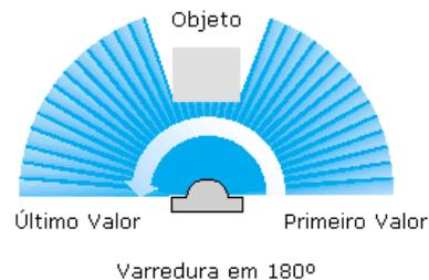
Fig. 4. Varredura realizada pelo sensor *laser*.
